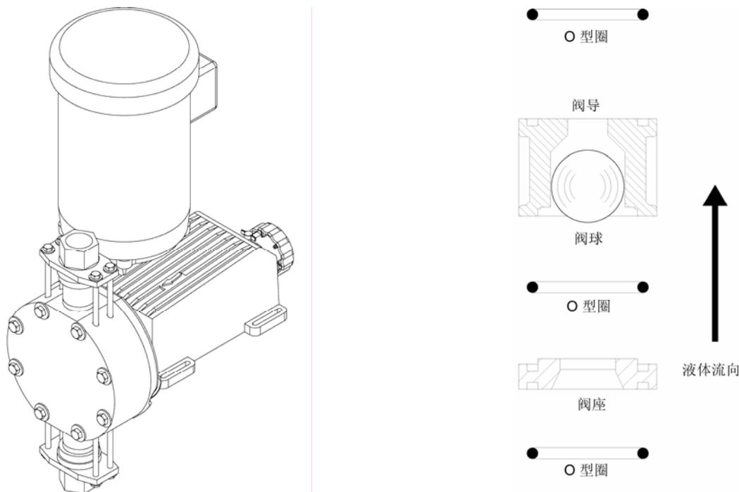
图 12, DC5 和 DC 6 止回阀, 金属结构
