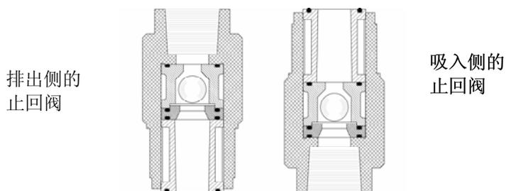
图 11 DC5、DC6 的塑料止回阀
