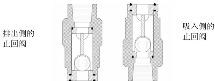
图 10 DC3、DC4 的止回阀
